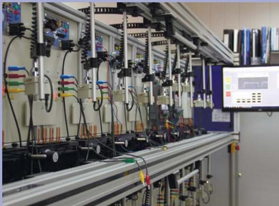
Автоматизированное рабочее место по поверке счётчиков электрической энергии
