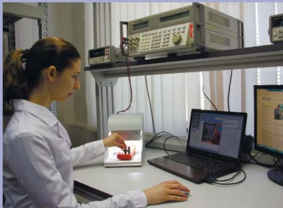
Автоматизированное рабочее место по поверке мультиметров с помощью машинного зрения включает аппаратную часть (камера, подсветка и корпус, в который помещается поверяемое средство измерений) и программное обеспечение, позволяющее считывать показания с дисплея мультиметра:
